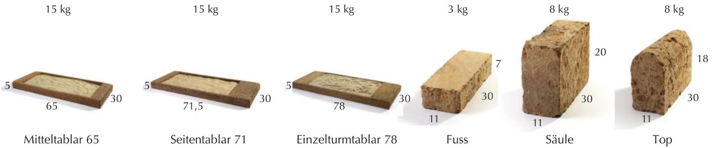
Montagehinweise: Elemente auf ebenem Boden waag- und senkrecht auf- und nebeneinander stellen. Kleine Unebenheiten sollten mit einem normalen Mörtel horizontal ausgeglichen werden. Ab einer Höhe über 1.6 m Regal mit der Wand verbinden. Belastung pro Tablar maximal 36 Flaschen. Für die Tablare nur den mitgelieferten Spezialsand verwenden.
